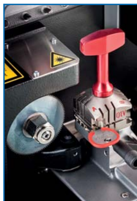
Frässtation für Flach- und Kreuzbartschlüssel
